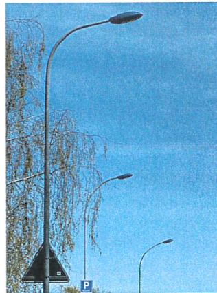
Candélabre en acier galvanisé à fouet
