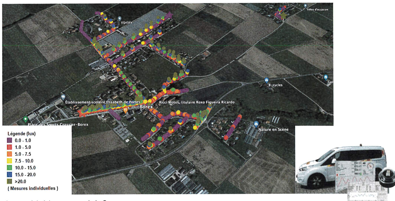
Véhicule et équipement de mesures automatisé par positionnement GPS
